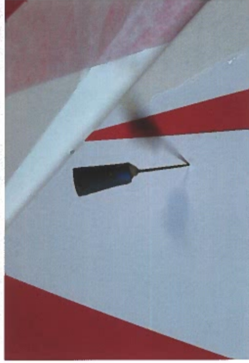
Eine (wirklich) spitze Nadel hilft beim Entfernen von Luftblasen. Es wird nur die Folie eingestochen und dann die Luft ausgedrückt. Damit sollte man aber ruhig einen Tag warten, denn etliche Blasen verschwinden von ganz allein.
