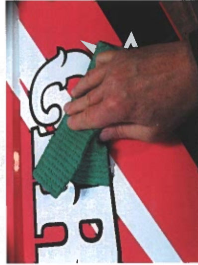
Bei doppelt aufzuziehenden Folien ist rund eine Stunde mit der zweiten Folie zu warten. Auch hier gilt vorsichtiges Abziehen des Transferpapiers in möglichst großem Winkel.
