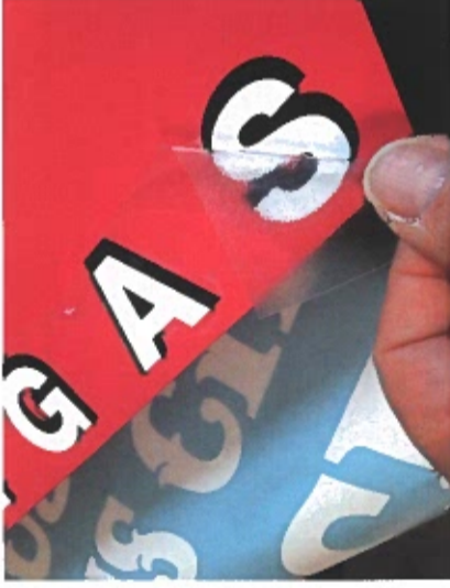
Mit übereinander liegenden Folien lassen sich tolle Tiefen- und Schatteneffekte erzielen. Eine transparente Transferfolie und das Nassverfahren sind unumgänglich. Nur so kann die zweite Folienlage genau zum Untergrund ausgerichtet werden.
